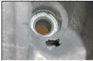
Corrosie aan het pluggat
