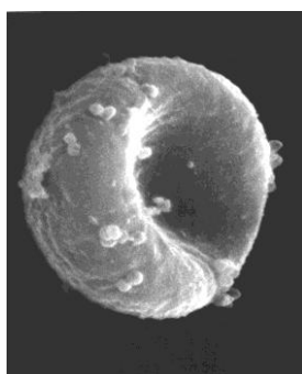
PTFE deeltjes op rood bloedlichaampje om de grootte der PTFE deeltjes te tonen
